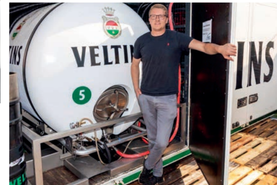
Der WGS verfügt über sieben Tankbier-Transporttanks, jeder einzelne fasst 3.000 l Bier. Die Transporttanks können sowohl zwischengelagert, als auch direkt von der Brauerei zum Gastronom gebracht werden.
